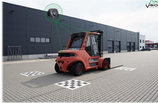
Mithilfe der Marker wird das System für den Einsatz kalibriert. Um das Fahrzeug herum wird ein Platzbedarf von mind. 1,2m benötigt. Dazu werden die vier Marker jeweils an den Fahrzeugkanten positioniert und das Bild aus der Steuereinheit exportiert. Durch das Kalibrierungstool kann das System innerhalb von 10 Minuten kalibriert werden. Ein Ausmessen der Abstände und Fahrzeugmaße ist nicht notwendig. Diese ermittelt das System automatisch.
